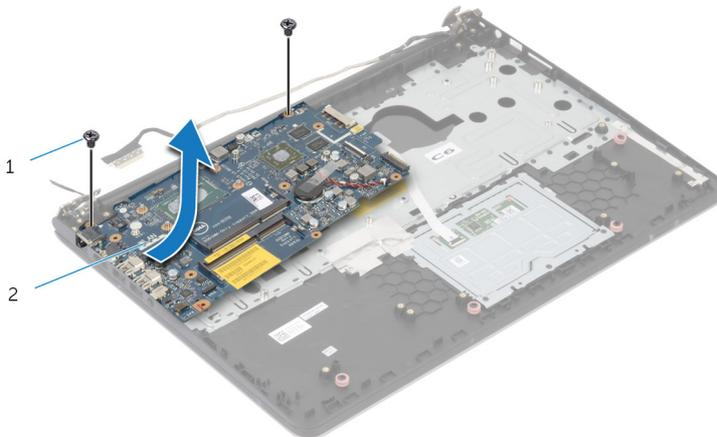
**3** Heben Sie die Systemplatine von der Handballenstütze.
